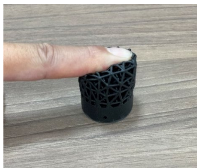
開発したラティス構造柔軟指と変形の様子
